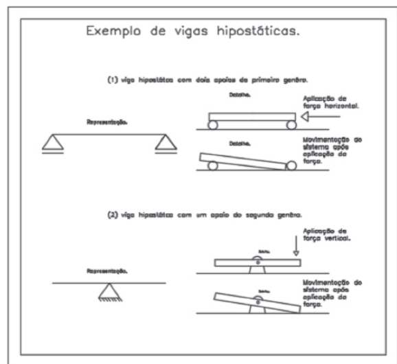
Figura 3 – Exemplos de vigas hipostáticas
