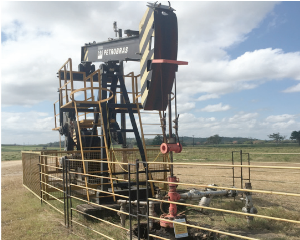
Figura 3 – Unidade de Bombeio Mecânico
