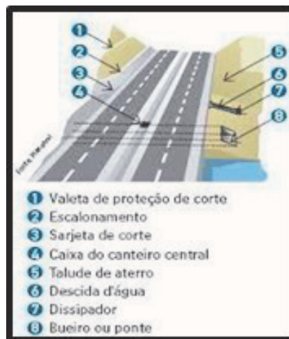
Figura 2 – Ilustração do sistema de drenagem superficial
