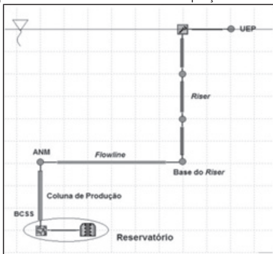
Figura 3 - Poço equipado com BCSS no fundo do poço
