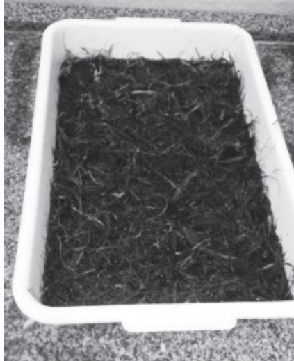
Figura 2 – Fibras de coco com imersão de hidróxido de sódio
