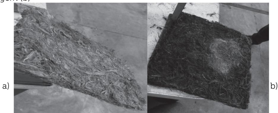
Figuras 7 – Manta de fibra de coco via seca com espessura de 9 mm obtida após prensagem (a) e manta de fibra de coco via úmida com espessura de 5 mm obtida após prensagem (b)
