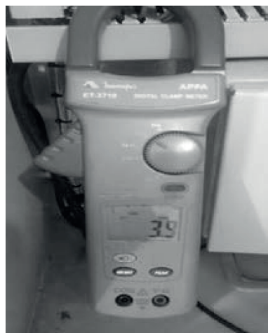
Figura 4 – Corrente observada no motor com a utilização de um partida direta
