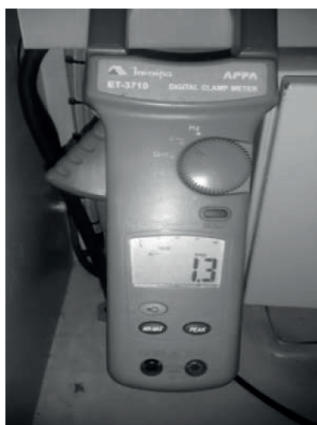
Figura 3 – Corrente observada no motor com a utilização do inversor de frequência. O aparelho utilizado foi um alicate amperímetro do fabricante Minipa, modelo ET3710
