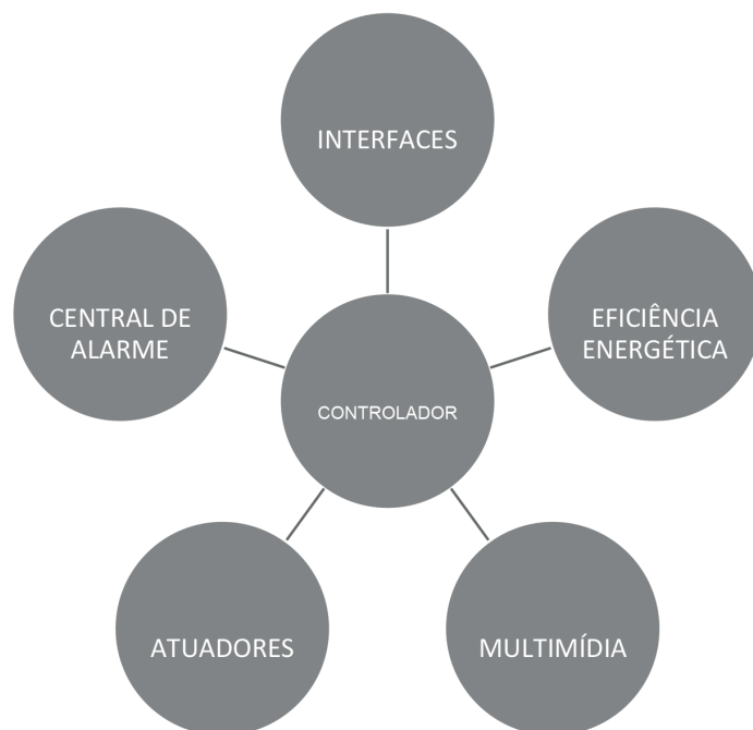
Figura 3 – Sistema de automação residencial centralizado
