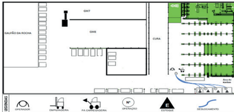
Figura 4 – Movimentação de MP depois do evento kaizen
