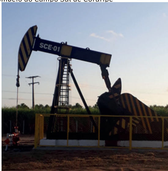
Figura 1 – Unidade de bombeio do Campo Sul de Coruripe
