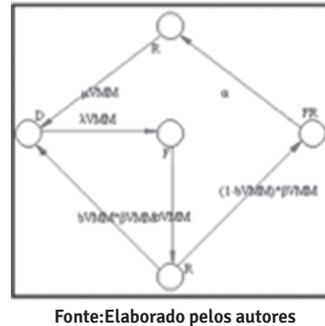
A Cadeia de Markov para o comportamento das máquinas virtuais é apresentada na Figura 11, possuindo 5 estados. No estado “Disponível” a máquina virtual está funcionando adequadamente. Ocorrendo uma falha no serviço, a cadeia passa para o estado “FalhaServico”. Com a falha sendo detectada passa para o estado “FalhaServicoDetectada”, neste estado a falha é corrigida e a cadeia retorna para o estado “Disponível”.
