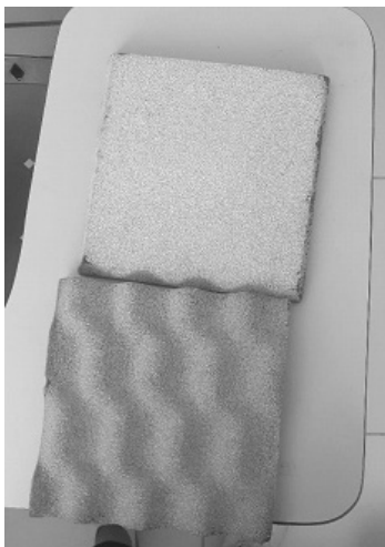
Figura 18 – Espuma acústica entre placas de drywall
