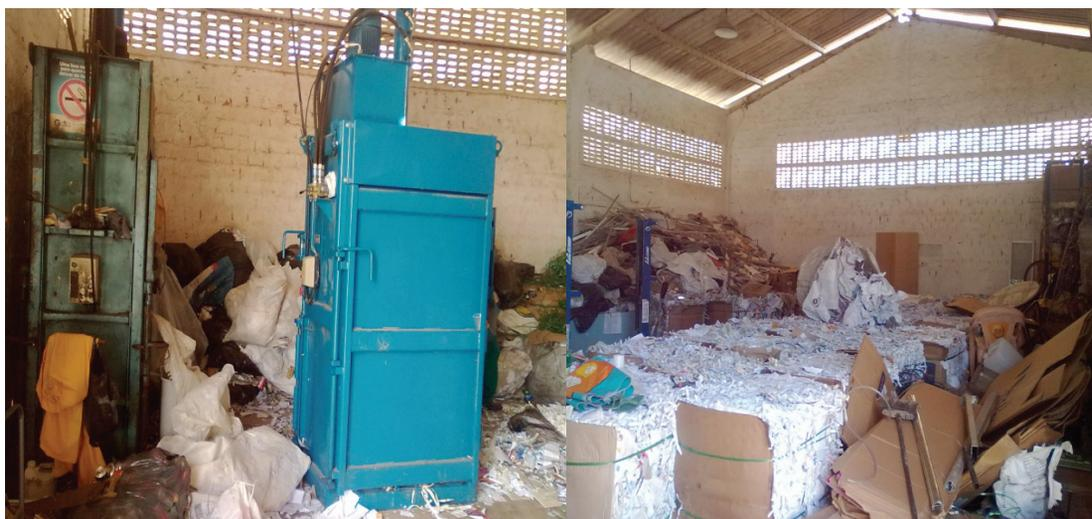
A usina de triagem de resíduos sólidos conforme figuras 2 e 3, é constituída basicamente de unidades de apoio, unidade de recepção dos resíduos, unidade de triagem, baias ou galpões para armazenamento de reciclável. O que não pode ser aproveitado descarta-se em aterro sanitário.
