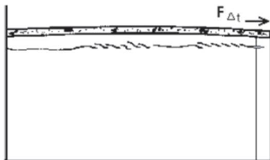
Figura 8 – Fissura típica de movimentação térmica de lajes sobre alvenaria portante
