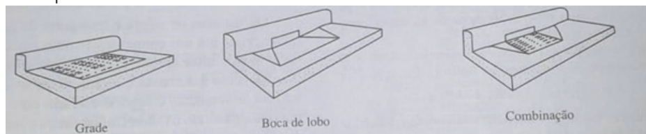
Figura 7 – Tipos de boca de lobo
