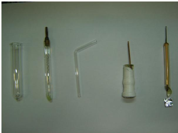
**Figura 4:** Eletrodo de trabalho com suporte de diamante
