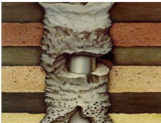
Figura 9 – Corrosão no Cimento
