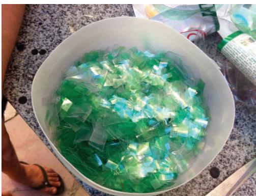
**Figura 1:** Garrafas de Politereftalato de Etileno cortadas.
