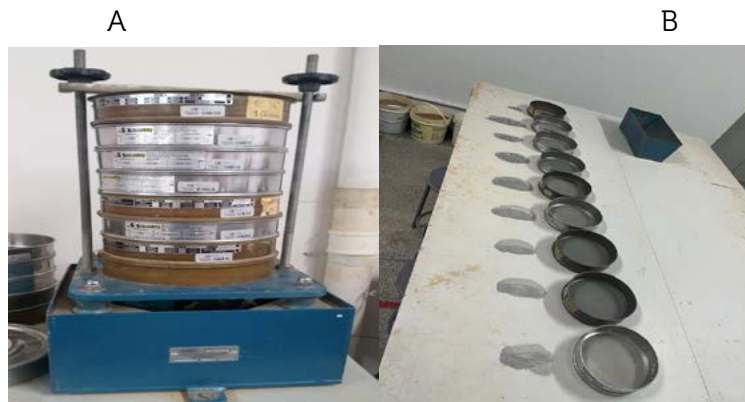
Figura 1 – A) Peneiramento, B) Partículas do resíduo
