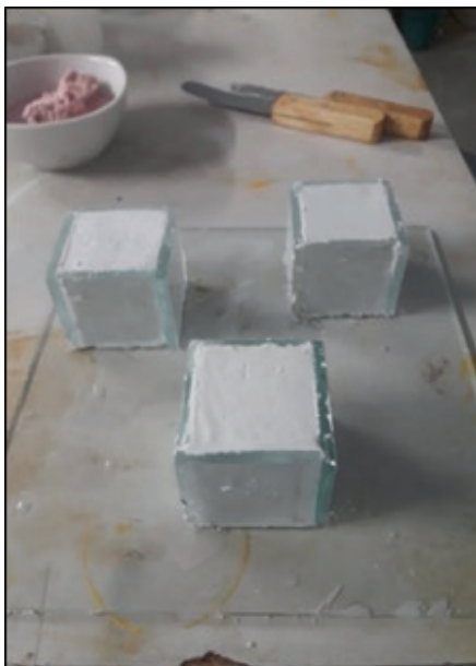
Figura 3 – Amostra em triplicata pronta para desmolde
